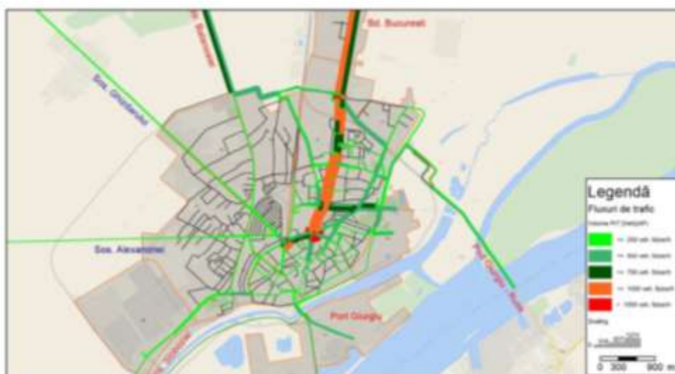
Figură 4-9 Traficul afectat pe rețeaua rutieră – Valori AM peak, vehicule fizice, anul 2015
